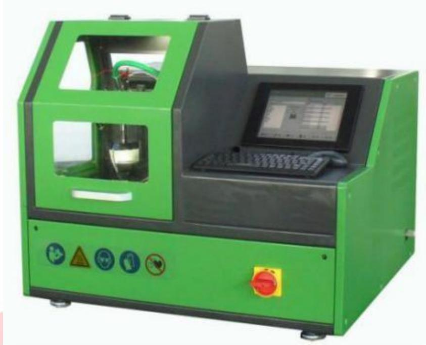
El banco de pruebas NTS206 es nuestro último dispositivo especial de investigación independiente para probar el rendimiento del inyector de riel común de alta presión, controlado por computadora industrial, sistema operativo Windows.
